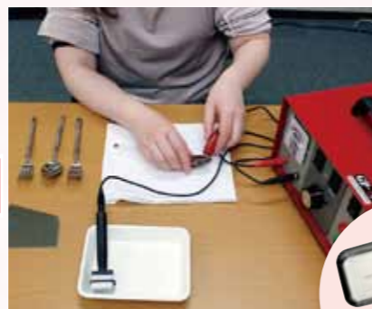
対象物にマスター(版)をセットしてプラグを繋ぐ。 通電前に電解液とマスターを馴染ませる。
