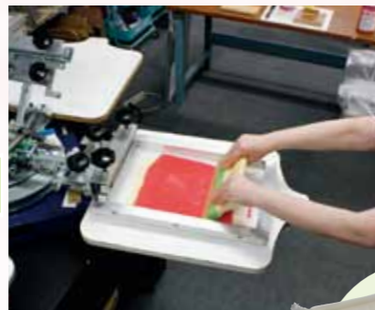
マスターをアルミ枠に紗張り して回転台にセット。水性イン クをのせてスキージする。
